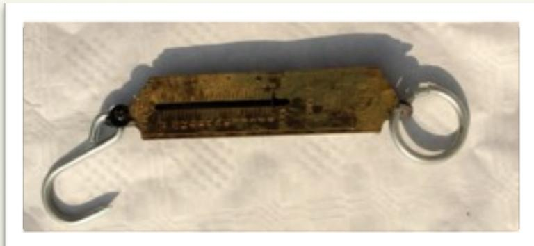
**Bild 1.3** Zugwaage zum Schätzen der Futtermenge
